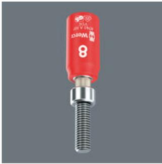
Die Klemmung der Innensechskant-Schraube auf der Bit-Nuss wird durch eine federnde Kugel auf dem Bit gewährleistet. Besonders hilfreich in schwer zugänglichen Arbeitsbereichen, wo man die zweite Hand nicht zum Festhalten der Schraube nutzen kann.
