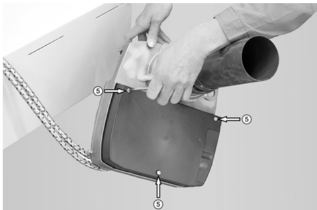
Fig. 2: Démontage du silencieux d'admission
