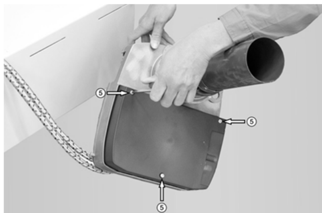
Fig. 2: Smontaggio del silenziatore di aspirazione
